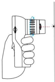
Halten Sie die Ein-/Aus-Taste (12) gedrückt, um den Bildschirm zu aktivieren. Platzieren Sie das zu beobachtende Objekt in der Mitte des Bildschirms. Drücken Sie kurz die LINKS-Taste (11) oder die RECHTS-Taste (14), um den Zoomlevel einzustellen, und verwenden Sie das Fokussierrad (16), um die Bildschärfe zu justieren.
