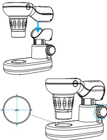
Placez l'objet à observer au centre de la zone d'observation de la table du microscope. Ajustez la hauteur de la table et observez les changements sur l'écran. Lorsque l'image devient claire, vous pouvez prendre des photos ou des vidéos.
