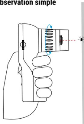
Maintenez enfoncé le bouton d'alimentation (12) pour activer l'écran. Placez l'objet à observer au centre de l'écran. Appuyez brièvement sur le bouton GAUCHE (11) ou DROITE (14) pour ajuster le niveau de zoom et utilisez la molette de mise au point (16) pour ajuster la clarté de l'image.
