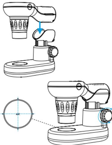
Coloque el objeto a observar en el centro del área de observación de la mesa del microscopio. Ajuste la altura de la mesa y observe los cambios en la pantalla. Cuando la imagen se vuelva clara, puede tomar fotos o videos.
