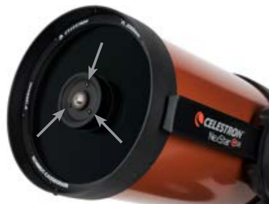
Collimazione dello specchio secondario regolando le viti
