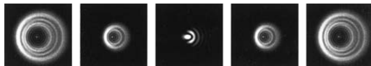
Collimazione dello specchio secondario regolando le viti
