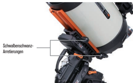
Abbildung 5 Teleskop-Schwalbenschwanz ausrichten und fixieren
