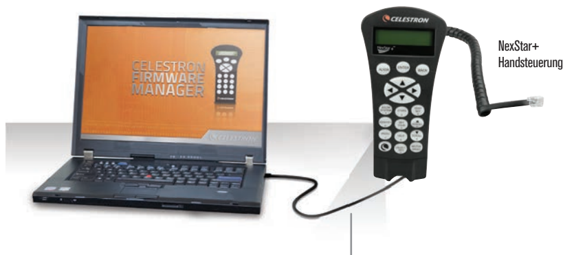
Abbildung 12.2 Aktualisieren der Handsteuerungs-Firmware
